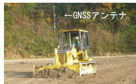
MC（マシンコントロール）ブルドーザ
